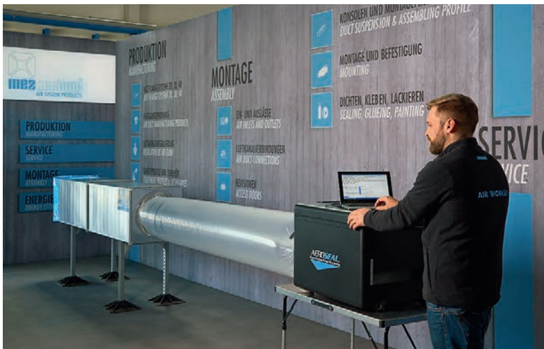
Ein Dichtheitstest zeigt eventuelle Schwachstellen des Systems.
